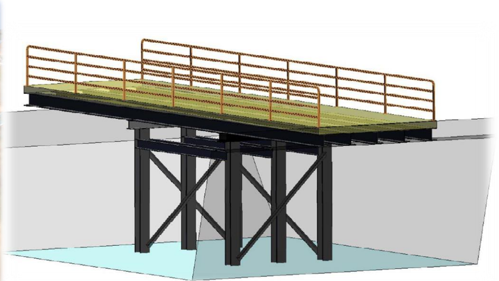
既存の鋼製仮設橋
