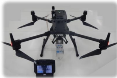
MATRICE 300RTK (レーザ測量用)
